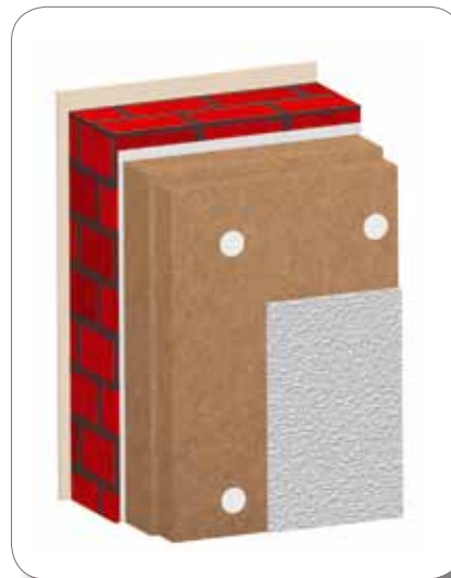
Fachada revocada, dos capas
